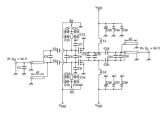
C1: 2 pF MICA CAPACITOR C2, C21: MICA CAPACITOR 1 pF MICA CAPACITOR 220 pF C3, C4: MICA CAPACITOR C5: 6 pF C6: MICA CAPACITOR C7, C8, C9, C10, C13, C14, C25, C28: 4700 pF CERAMIC CAPACITOR C11, C12, C15, C16: 10000 pF CERAMIC CAPACITOR C17, C18: MICA CAPACITOR 8 pF CERAMIC CAPACITOR C19, C20:  $200 \text{ pF} \times 2$ C22: MICA CAPACITOR 3 pF
